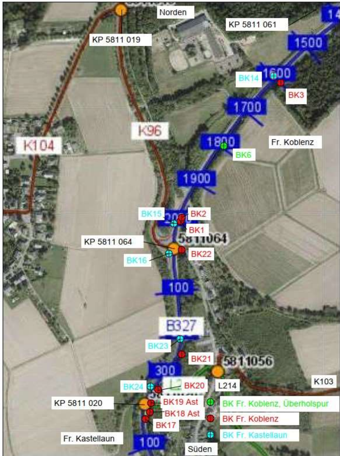
Luftbildaufnahme mit Angaben zu den Bohrkernentnahmestellen
