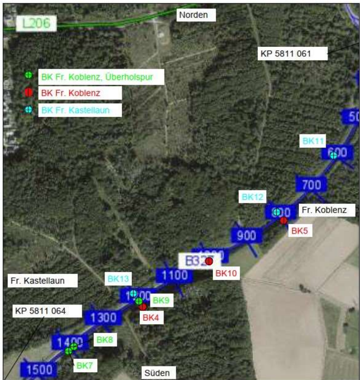
Luftbildaufnahme mit Angaben zu den Bohrkernentnahmestellen
