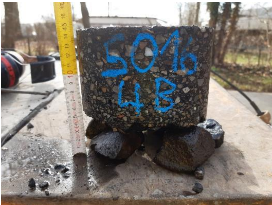
Bild 11: Detailaufnahme, Bohrkern aus BK 4B
