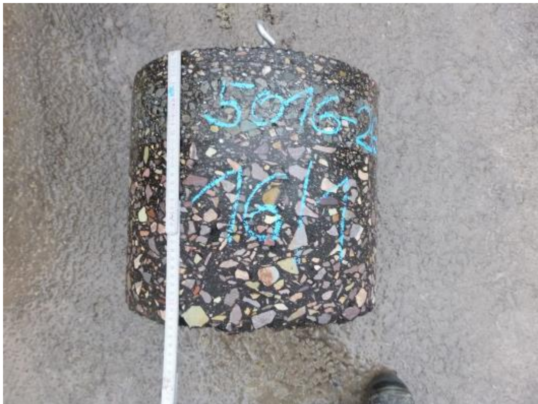
Bild 43: Detailaufnahme, Bohrkern aus EK 16
