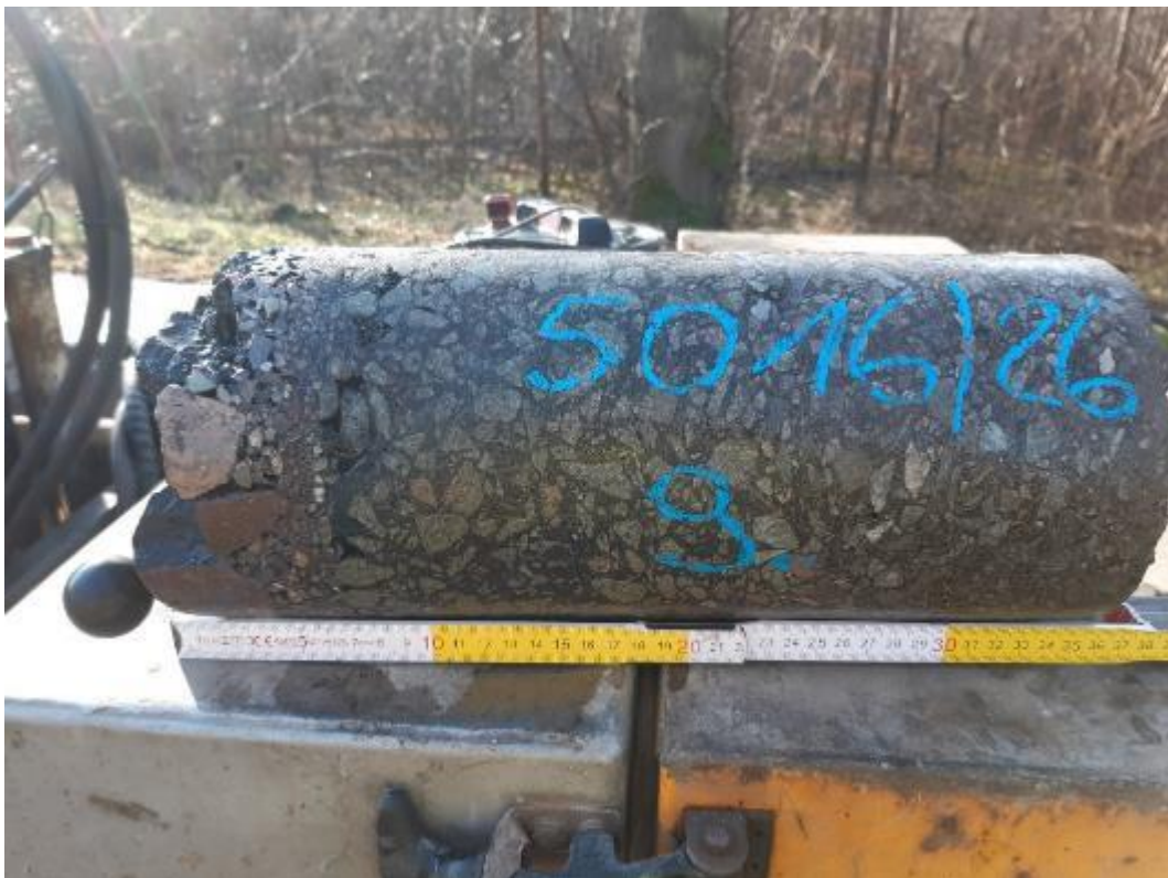
Bild 25: Detailaufnahme, Bohrkern aus BK 9
