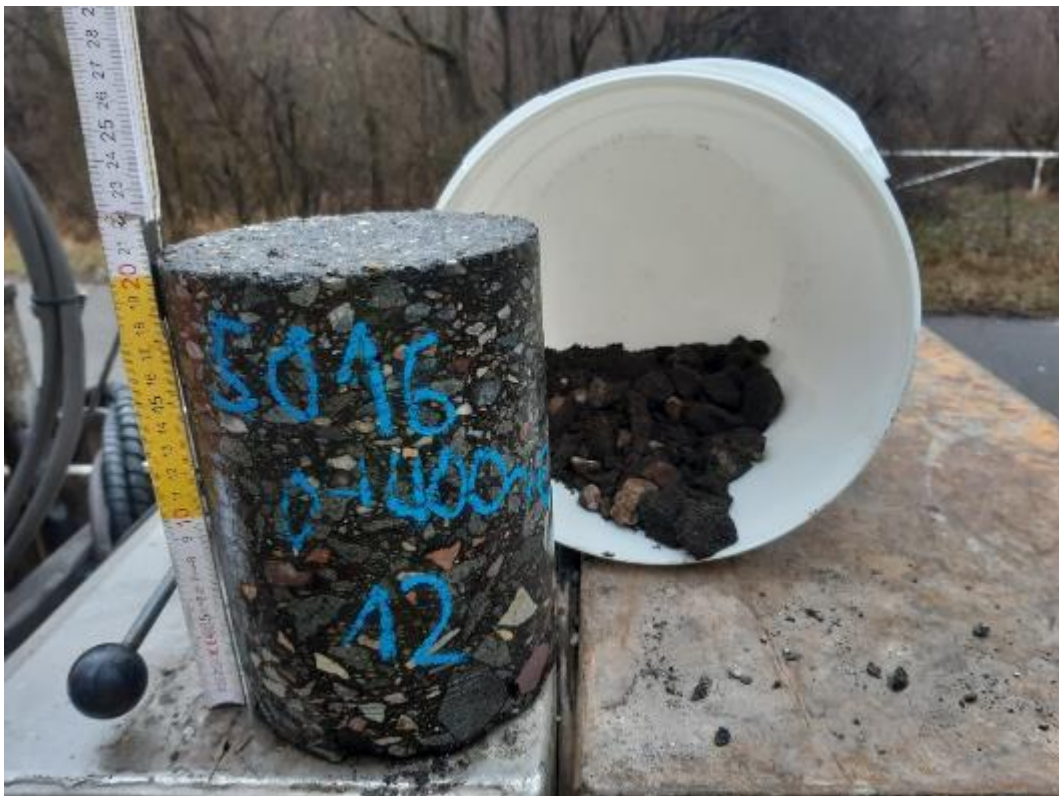
Bild 31: Detailaufnahme, Bohrkern aus BK 12
