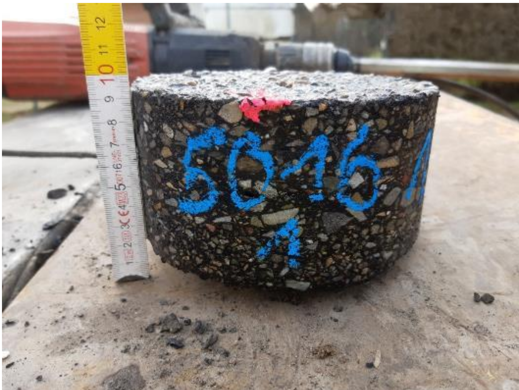
Bild 2: Detailaufnahme, Bohrkern aus BK 1
