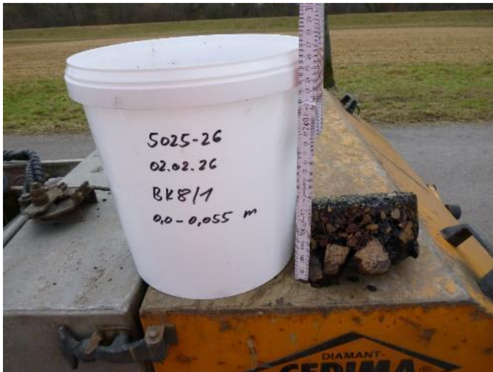
Bild 16: Detailaufnahme, Bohrkern aus BK 8
