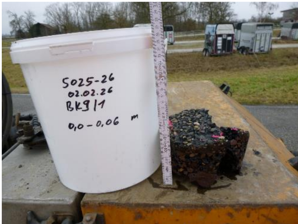
Bild 18: Detailaufnahme, Bohrkern aus BK 9
