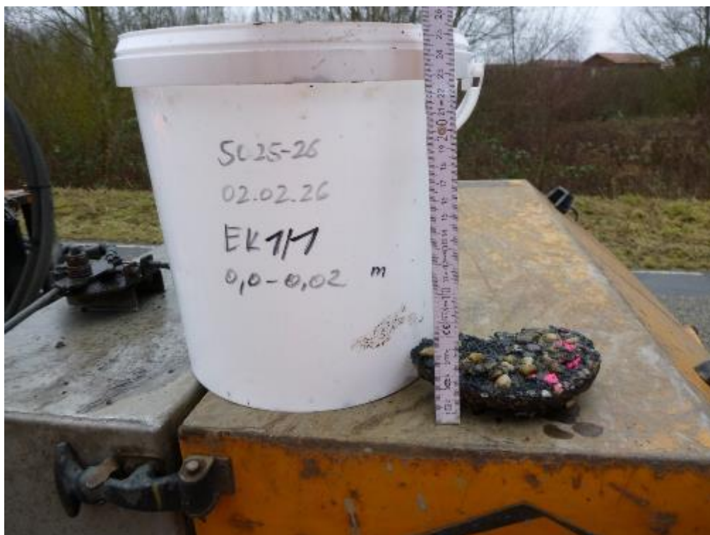
Bild 2: Detailaufnahme, Bohrkern aus BK 1
