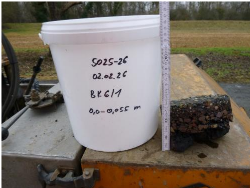
Bild 12: Detailaufnahme, Bohrkern aus BK 6
