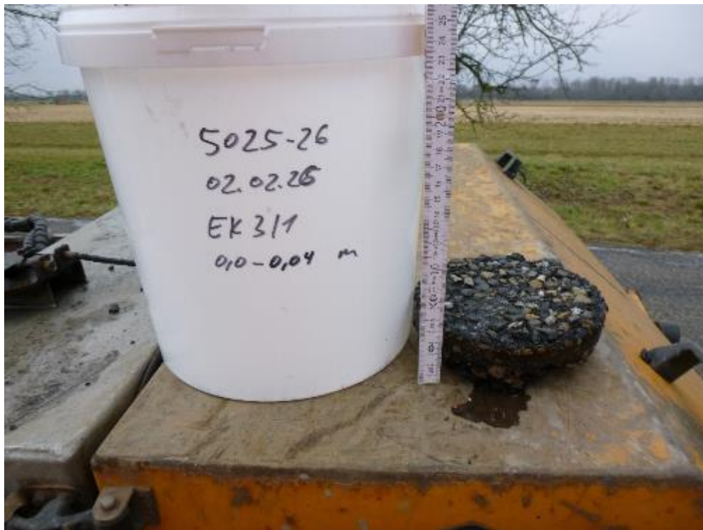
Bild 6: Detailaufnahme, Bohrkern aus BK 3
