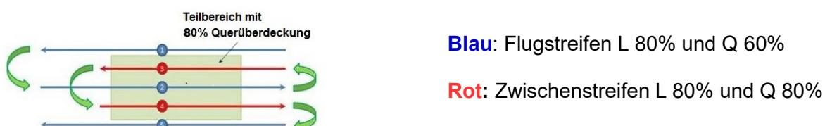
Die Nummerierung der Flugstreifen und Bilddateien soll fortlaufend erfolgen (wie beflogen). Für die Befliegung der Zwischenstreifen gelten die gleichen Spezifikationen der Leistungsbeschreibung.
