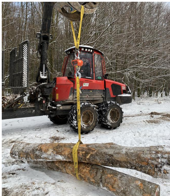
Abbildung 13: externe Hakenwaage zur Ermittlung des Referenzwertes für die Kontrollmessung der Kranwaage
