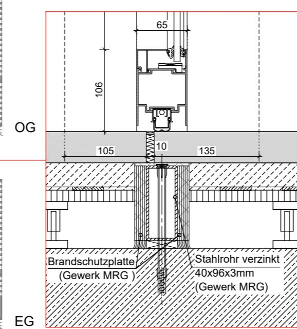
Bodenanschluss mit Stahlschwelle
