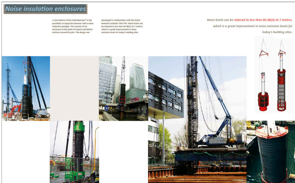
Abbildung 2: Schallschutzkamin zur Verringerung der Rammgeräuschimmission [46]
