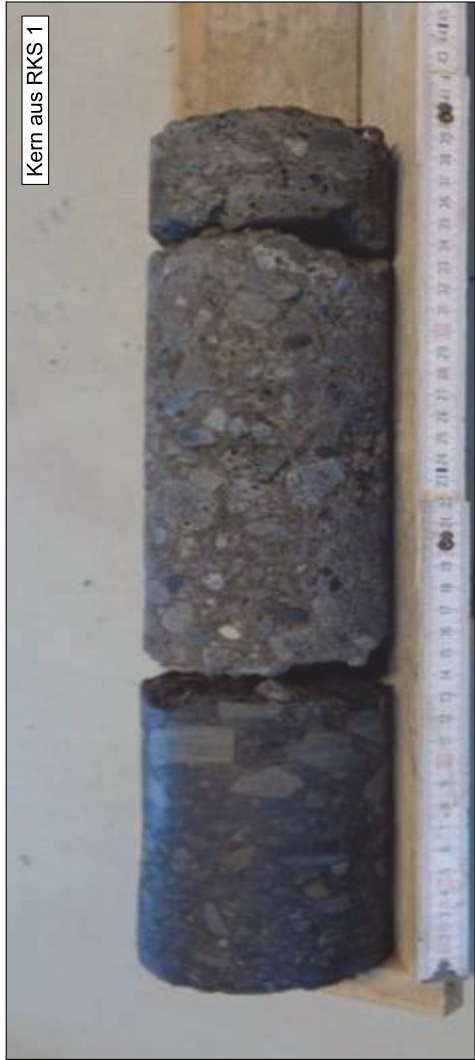
14 cm Asphalt, 26 cm Beton- u. Schlacke
