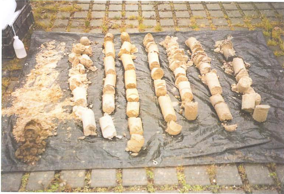
ausgelegte Bohrstrecke (Hohlschneckenbohrung mit Sedimentkern aus PVC- Liner DN 80)
