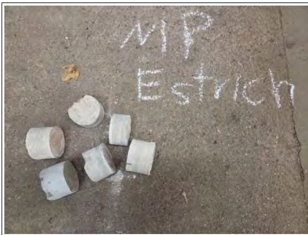
Foto 41: Aus den Estrichbohrkernen der Kernbohrungen KB 1, KB 2 und KB 4 bis KB 7 wurde die Mischprobe MP Estrich gebildet.
