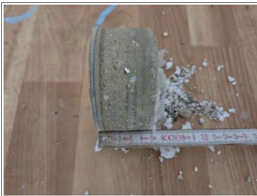
Foto 38: Detailansicht des 4,0 cm starken Estrichbohrkerns der KB 7. Die Estrichbohrkerne wurden zu einer Mischprobe zusammengefasst und untersucht.
