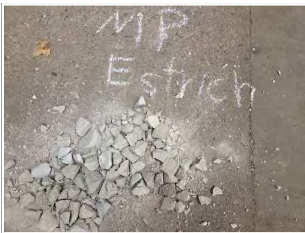
Foto 42: Das Foto zeigt das vorzerkleinerte Material der Mischprobe MP Estrich. Diese Mischprobe wurde vollständig auf den verdachtsunabhängigen Mindestuntersuchungsumfang analysiert und nach der Ersatzbaustoffverordnung (EBV) bewertet.
