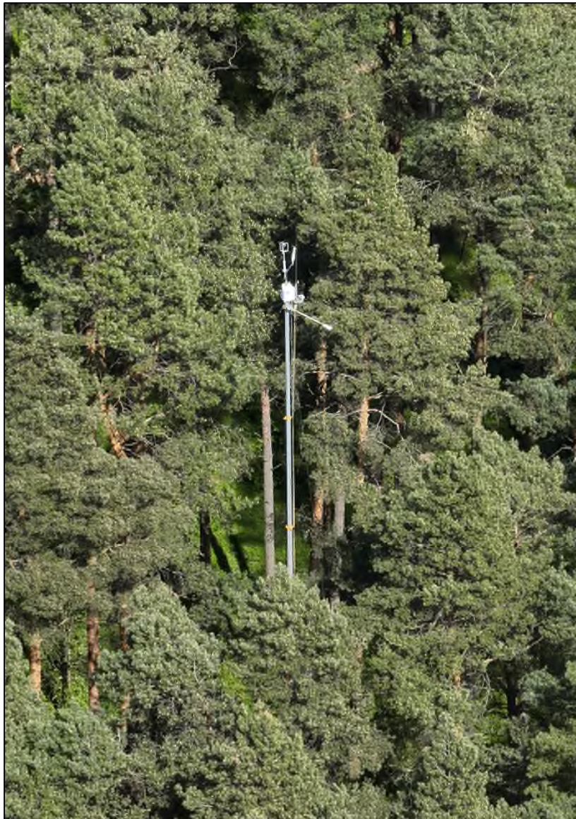
Abb. 3: Vorhandener „Eddy-Tower“ auf einer mobilen Stafette auf der Level II Fläche 1203 „Kienhorst“ (Foto F. Becker 13. Mai)
