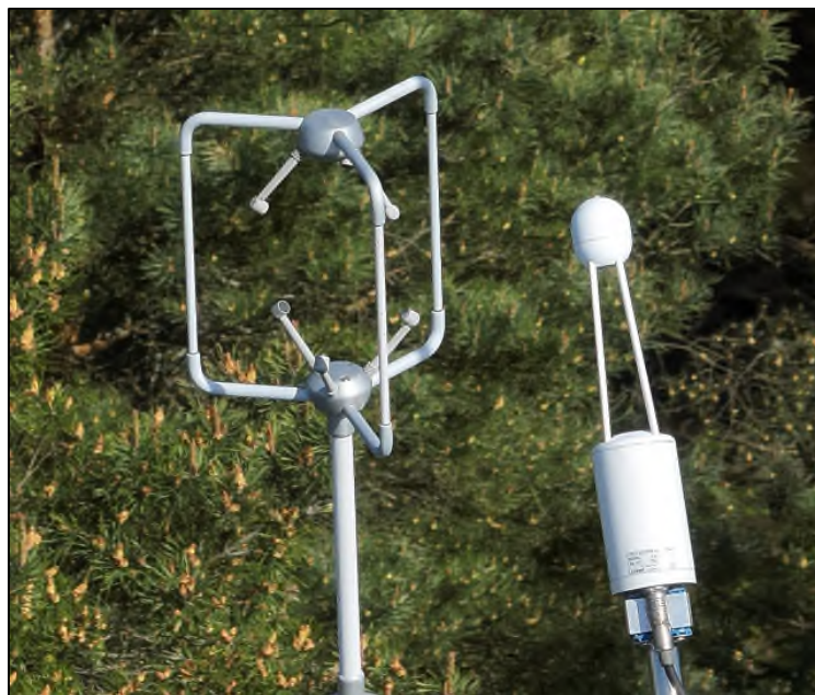
Abb. 2: Eddy-Kovarianz Messfühler auf der Level-II-Fläche 1203 „Kienhorst“ (Foto F. Becker 13. Mai 2025)
