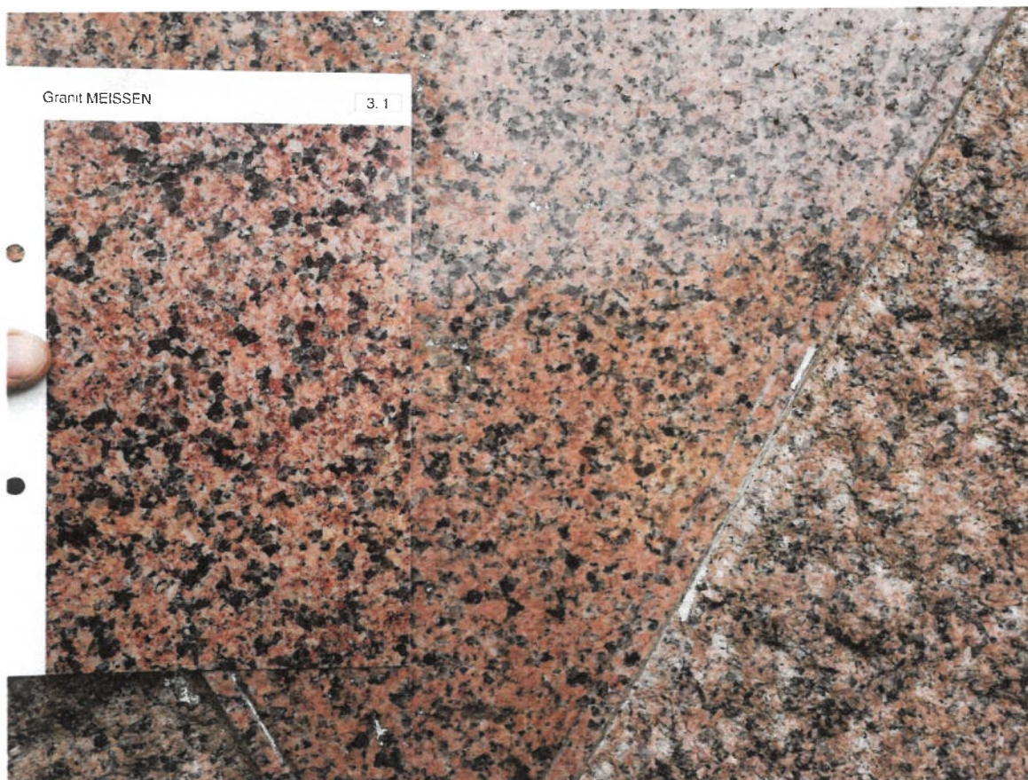
Abbildung 20 Materialbestimmung mit der Internationalen Natursteinkartei
