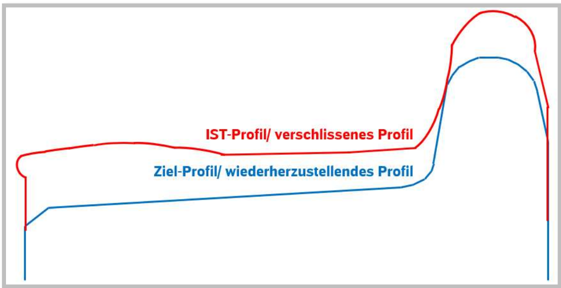
Abbildung 9: grafische Bedienerunterstützung Profilauswahl am Bsp. Vollbahnprofil [DB Systemtechnik GmbH, VQ.TVI 12]
