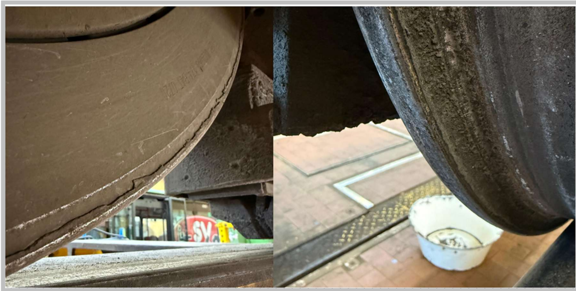
Abbildung 12: Spurkranzüberwalzungen am VBBR-Rad [nach VBBR]
