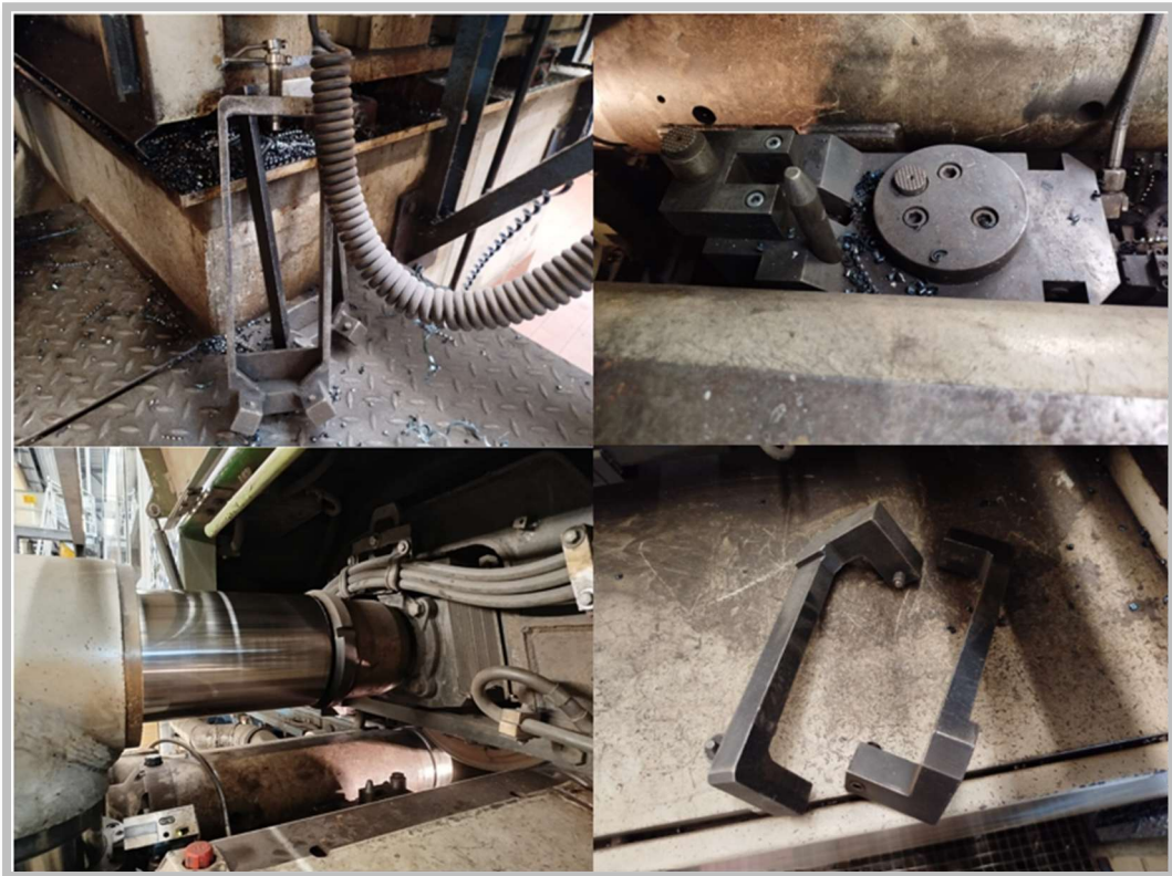
Abbildung 8: Aktuelle Einspannwerkzeuge [DB Systemtechnik GmbH, VQ.TVI12]
