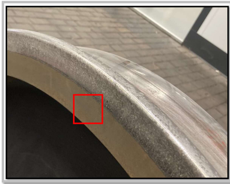
Abbildung 17: Antastbereich für l , r , s und lokales Profilkoodinatensystem [DB Systemtechnik GmbH, VQ.TVI 12]
