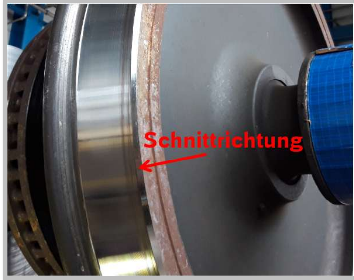
Abbildung 13: Schnittrichtung Überwalzungsentfernung am Bsp. Vollbahnrad [DB Systemtechnik GmbH, VQ.TVI 12]
