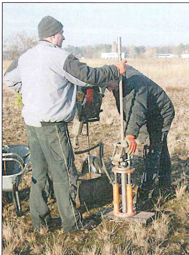
Foto 3: Bohrarbeiten zur Gewinnung der Bodenproben
