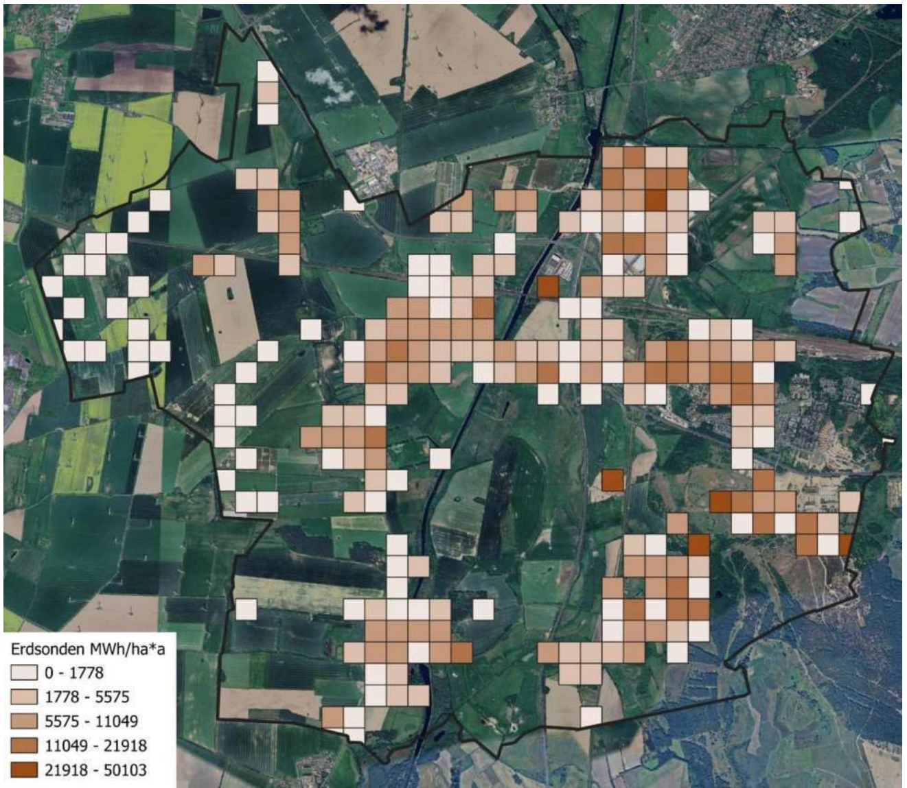
Abbildung 33: Geothermisches Potential durch den Einsatz von Erdsonden in Kombination mit Wärmepumpen (Quelle: FACT)
