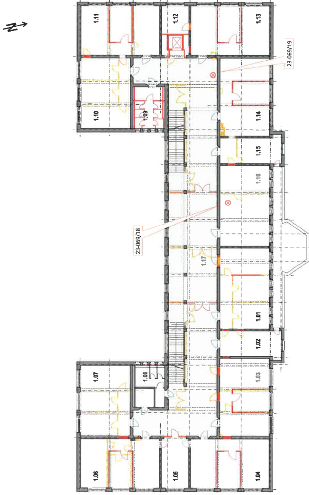
Anlage 7: Bestandsplan mit Position Kernbohrungen – 1. Obergeschoss
