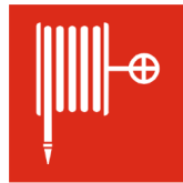
Löschschlauch in einem Wandhydrant
