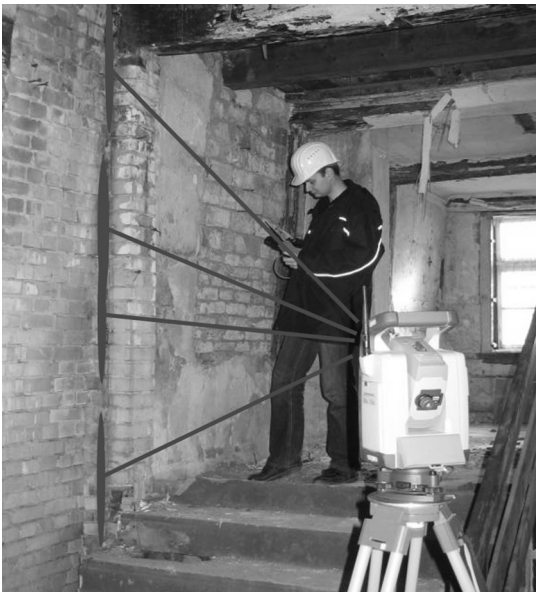
①④ Laserscanning im Bestand
