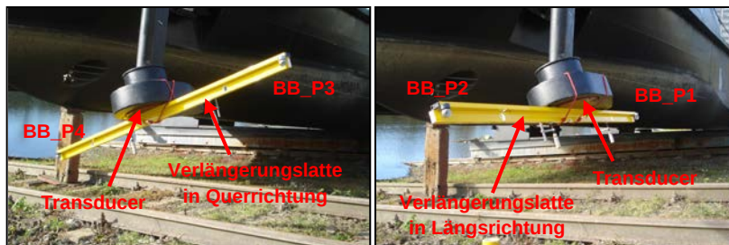
Abb. 13: Beispiel für die Verwendung einer Verlängerungslatte am Backbord-Transducer
