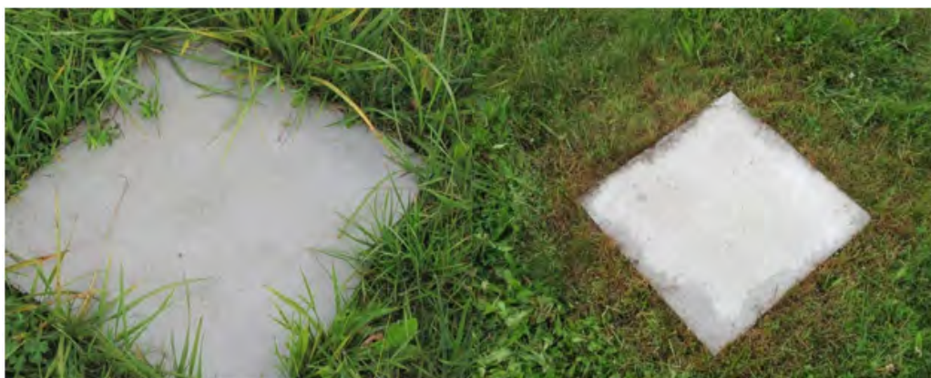
Abbildung 12: Schneebrett mit Negativbeispiel „zugewachsen“ und Positivbeispiel „frei“
