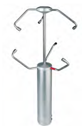
Abbildung 35: Verschiedene Ultraschallsensoren zur Windmessung
