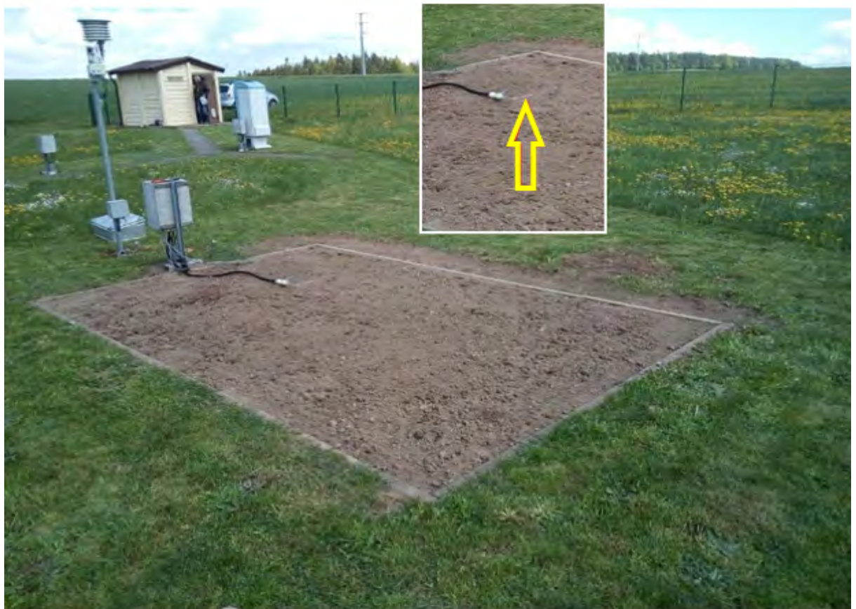
Abbildung 31: Erdbodenmessfeld Position der Messfühler
