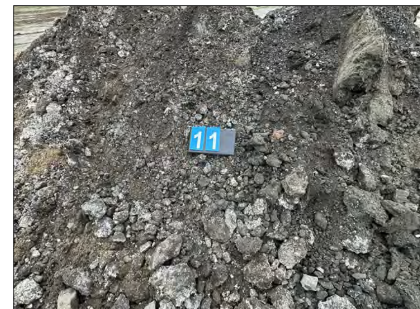
Abb. 2: Schurf ST 1.2 - Haufwerk (Altablagerung)
