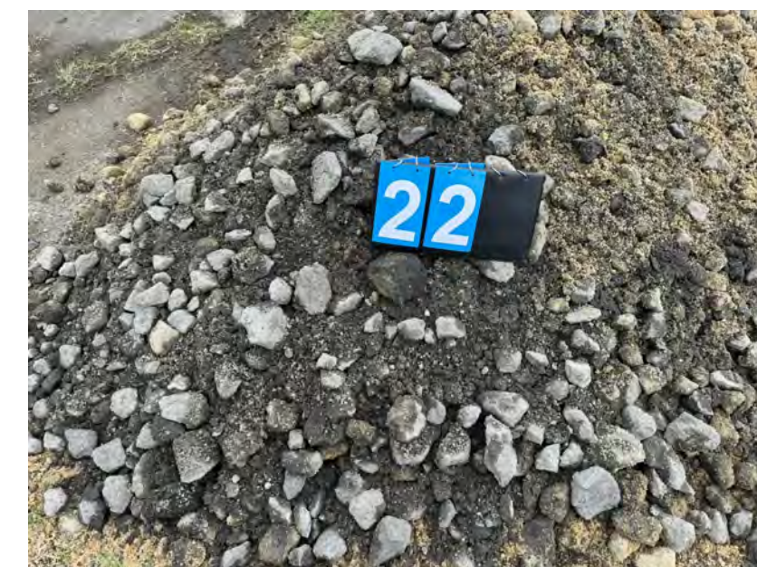
Abb. 5: Schurf ST 2.2 - Hauwerk (Gleisschotter aus der Altablagerung)
