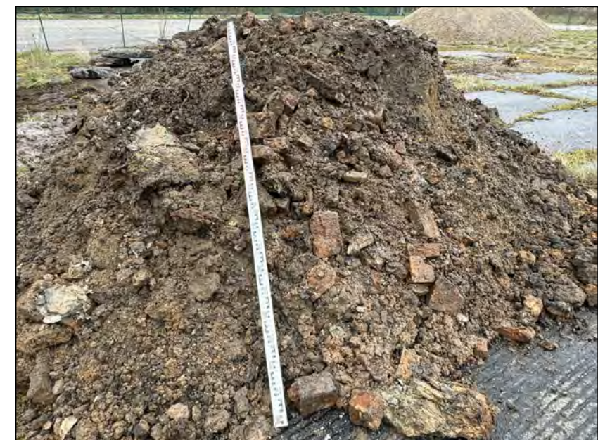
Abb. 15: Schurf WP (ehem. Waschplatz) - Haufwerk (Altablagerung)
