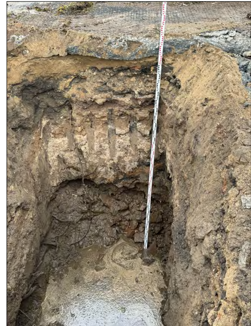
Abb.14: Schurf WP (ehem. Waschplatz) - Profil mit Wasserzutritt
