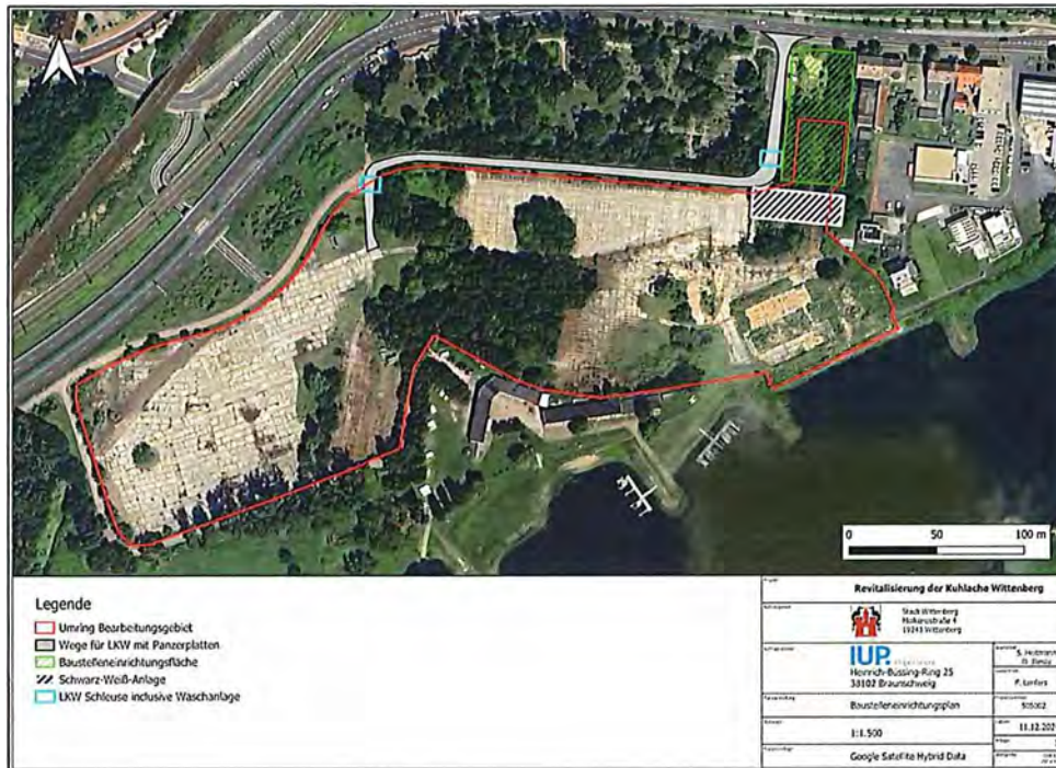
Abbildung 9: Baustelleneinrichtungsplan der Flächensanierung (IUP (2025))
