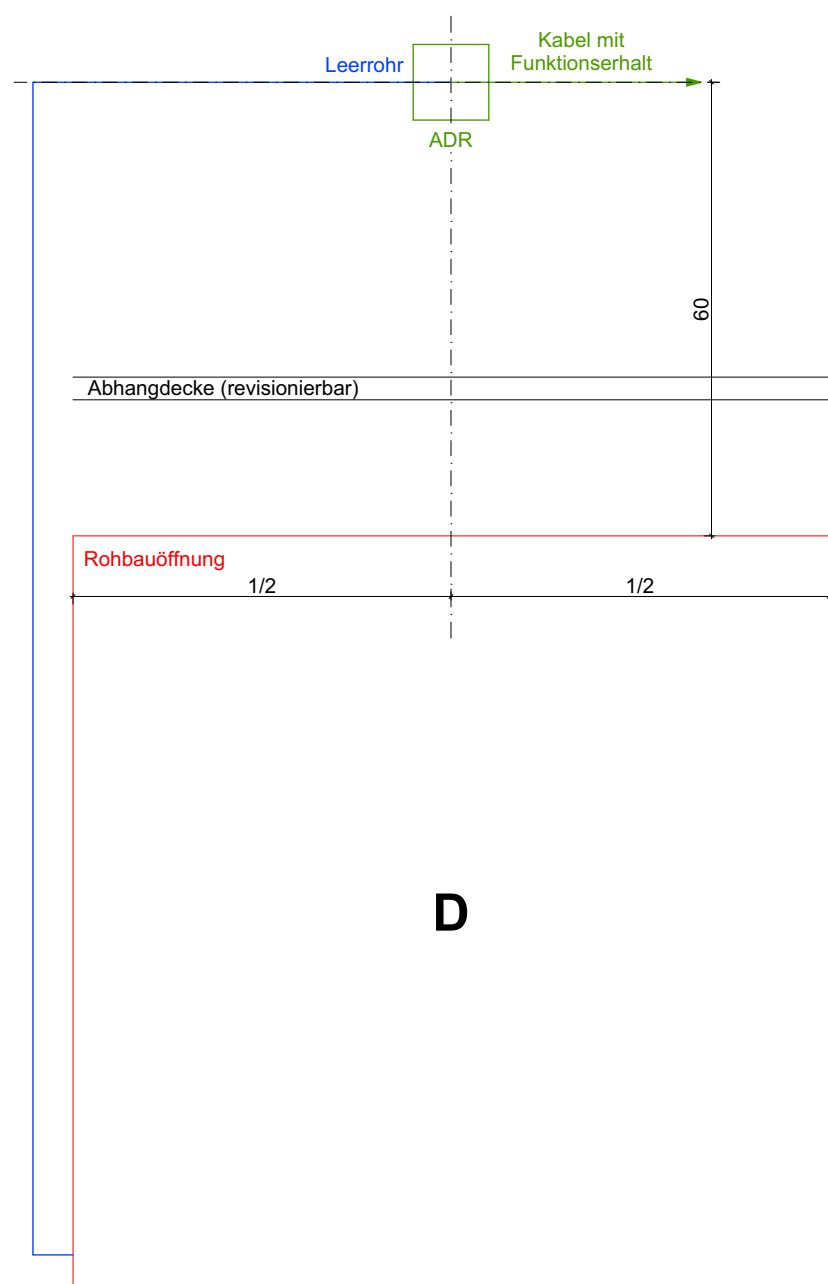
Einbauvariante D: oberhalb nur ADR (händisch öffnbare Fenster)
