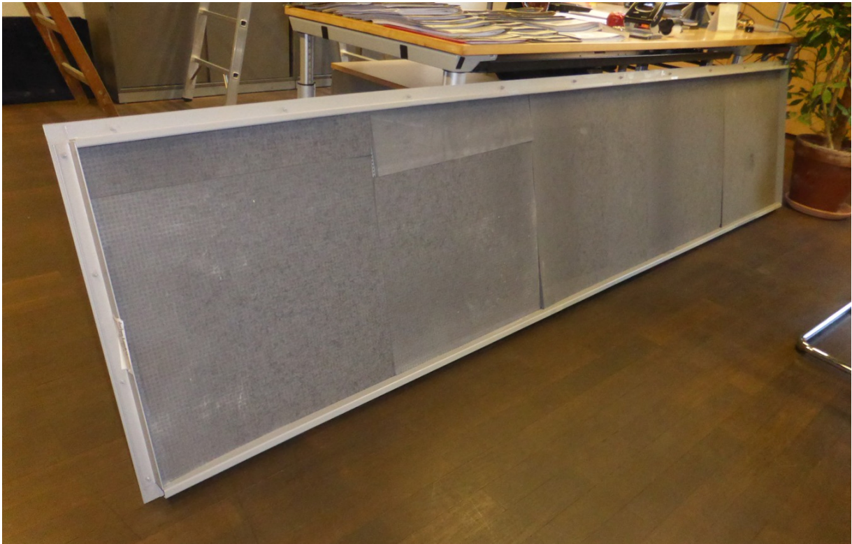
Abb. 8 aufgebautes Langfeld-Element mit Vlies
