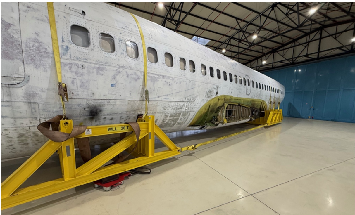
Abbildung 2: Rumpf auf Unterkonstruktion und Schwerlastrollen befestigt über Spannbänder
