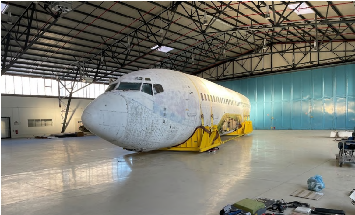
Abbildung 1: Rumpf auf Unterkonstruktion in der Ausstellungshalle
