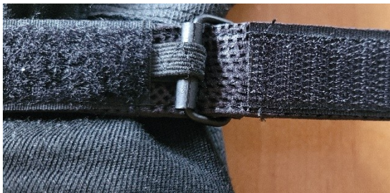
Abbildung 7: Fixierung der Zuglasche an der Umlenkrolle
