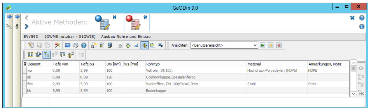
Abb. 18: Maske Ausbau Rohre und Einbau
