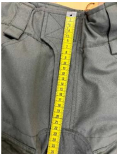
Abbildung 44 Hosenschlitz mit angeschnittener Bundverlängerung
