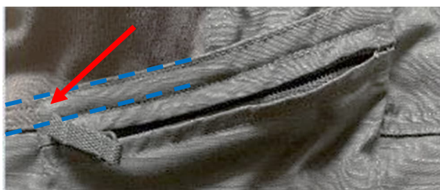
Abbildung 60 Detail: Nahtverlauf der vorderen Oberkante Tasche mit RV
