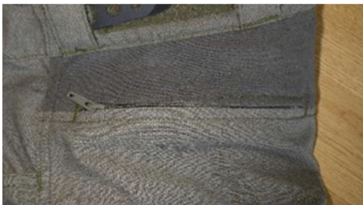
Abbildung 47 Verarbeitung Reißverschluss an Seitennaht und an der Teilungnaht
