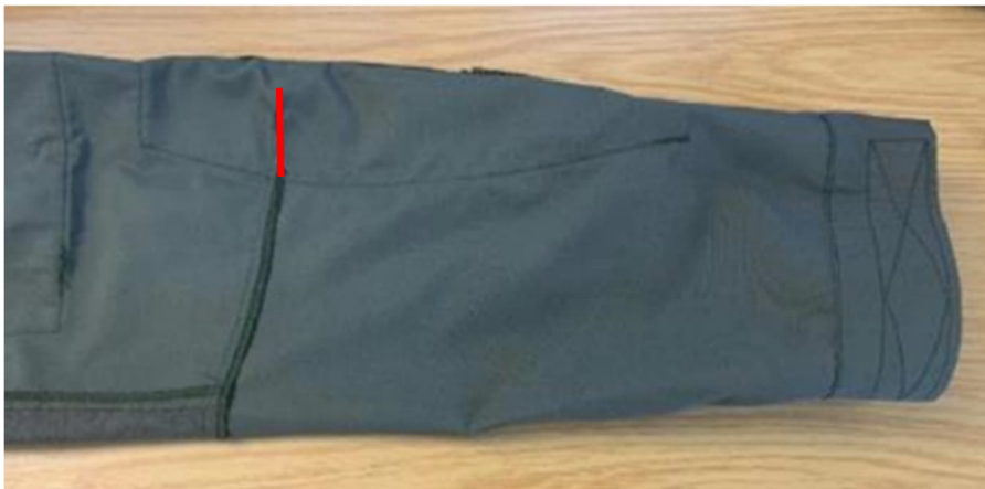
Abbildung 17 Detail: Ärmel – Abnäher in rot und Teilungsnahte Verarbeitung innen
