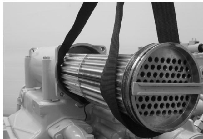
Abb. 95: Ausbau des Rohrbündels (Beispiel)
