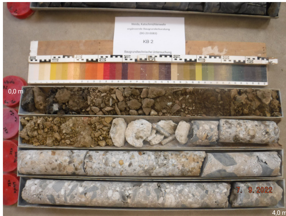
Abb. 4: Bohrkern – KB 2 (0,0 - 4,0 m unter GOK)
