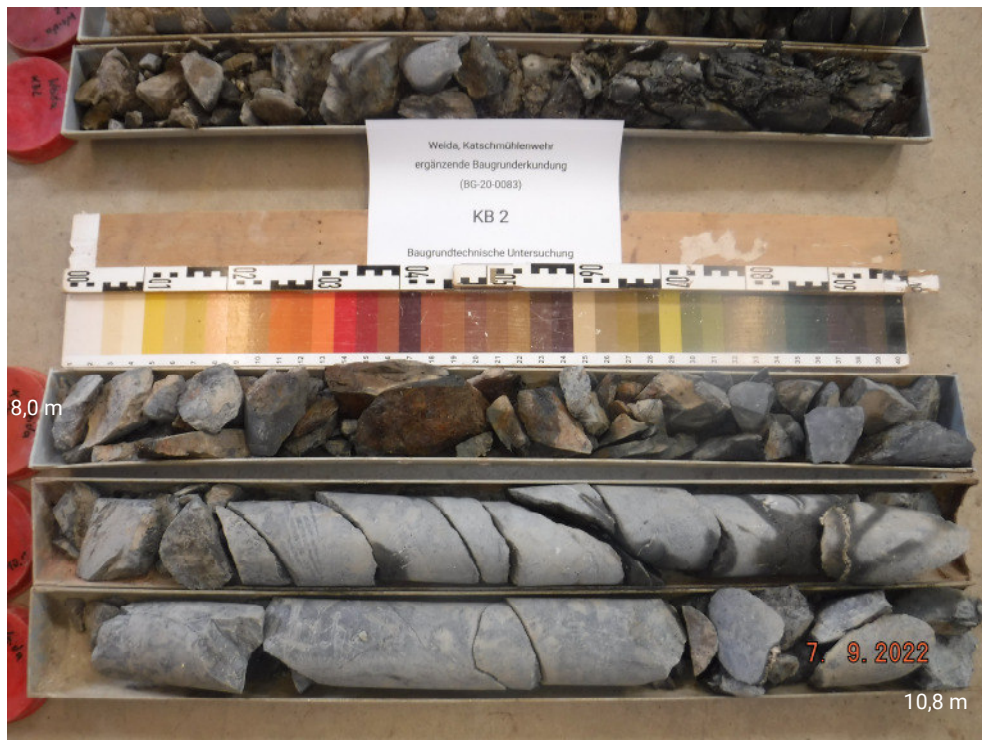
Abb. 6: Bohrkern – KB 2 (8,0 - 10,8 m unter GOK)
