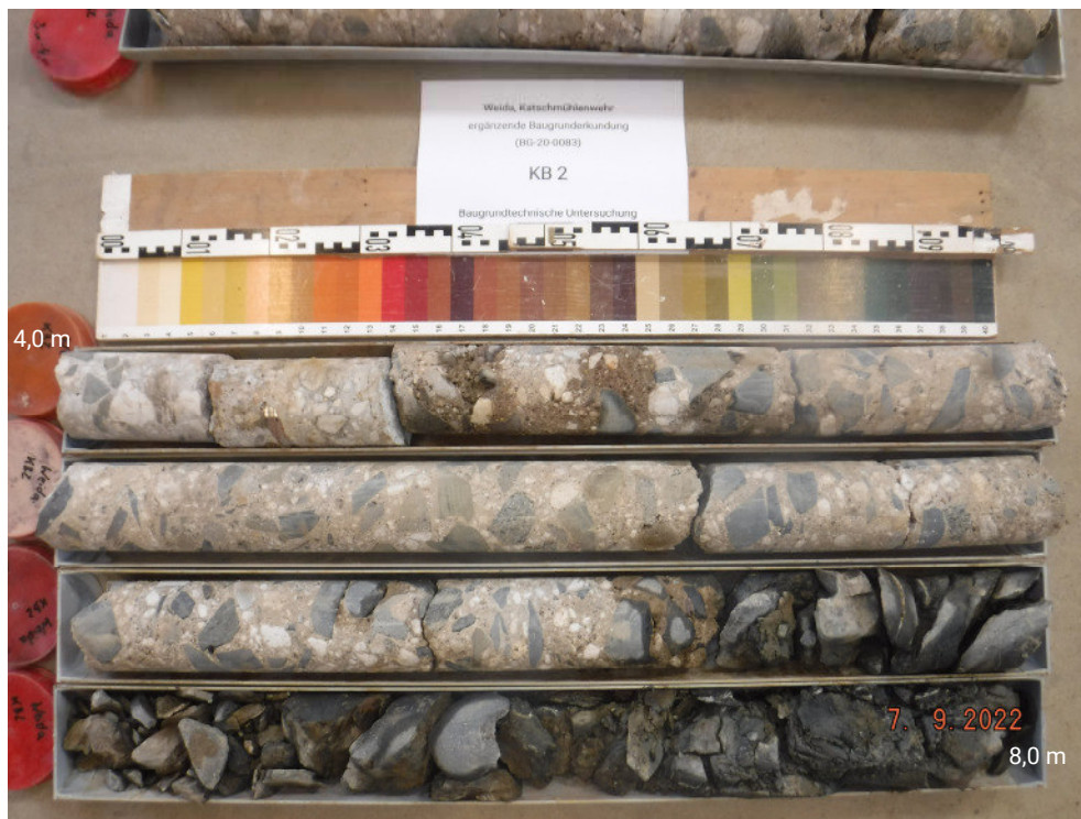
Abb. 5: Bohrkern – KB 2 (4,0 - 8,0 m unter GOK)
