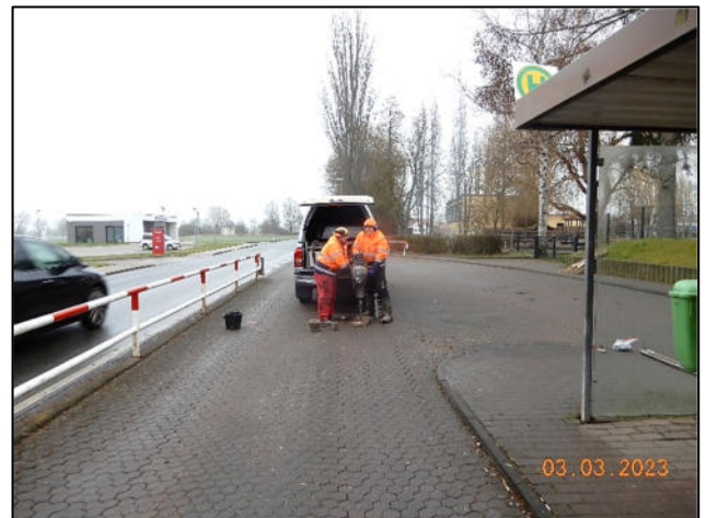
Durchführung der Kleinrammbohrungen (KRB) Oben KRB 1; rechts KRB 2; unten KRB 3
