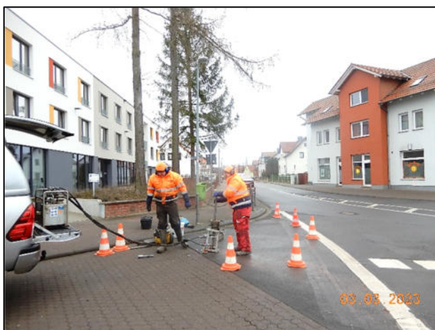
Durchführung der Kleinrammbohrungen (KRB) Oben KRB 1; rechts KRB 2; unten KRB 3
