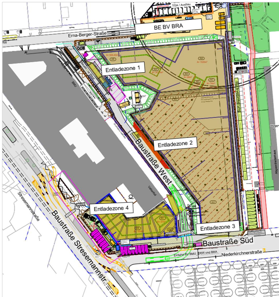
Abbildung 4: Tore und Entladezonen ab Bauphase Rohbau
