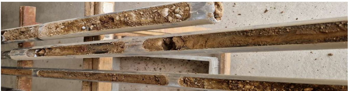
Bild 5: Erdstoff unterhalb des Asphaltkerns
