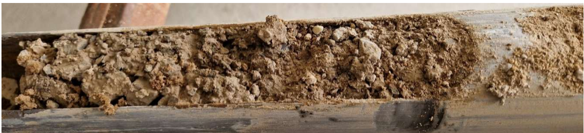
Bild 7: Auffüllung in der Sonde
