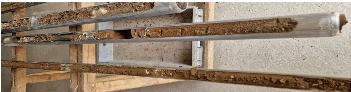
Bild 6: Erdstoff unterhalb des Asphaltkerns
