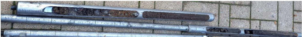
Bild 9: Auffüllung in der Sonde
