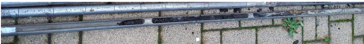
Bild 12: Übergang Auffüllung zum Ton (BS 10/22)
