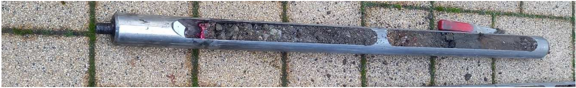
Bild 8: Auffüllung in der Sonde
