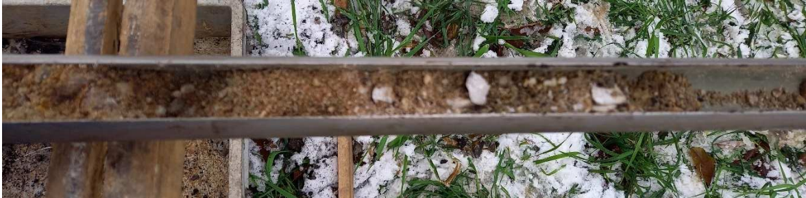
Bild 14: fluviatiler Sand mit Kiesen (BS 12/22)
