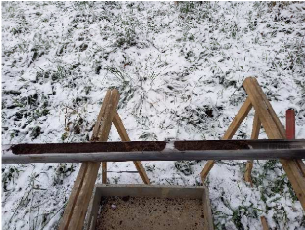
Bild 6: humifizierter Boden in der Sonde
