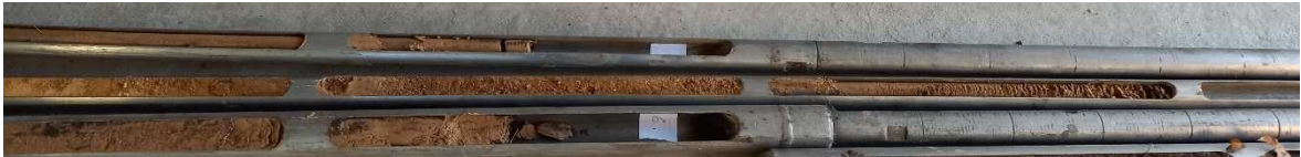
Bild 13: Verwitterungslehm – fluviatiler Sand – Geschiebemergel (BS 6/22)
