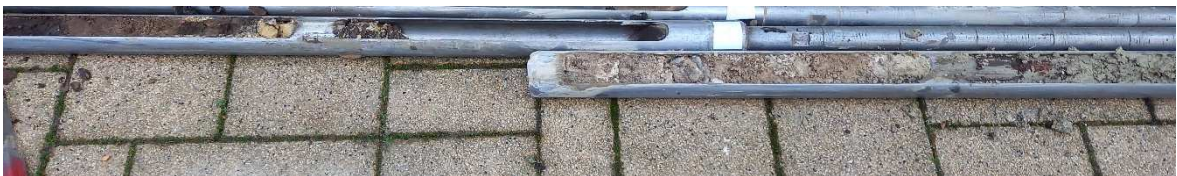
Bild 10: Auffüllung und Übergang Auffüllung zum Auelehm (Bereich oben links)
