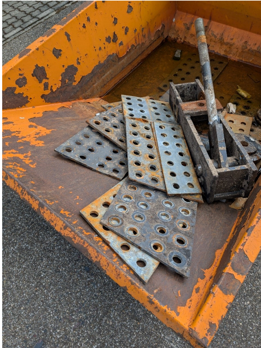
Abbildung 2: Verbogene Montagebleche nach fast unmöglicher Demontage
