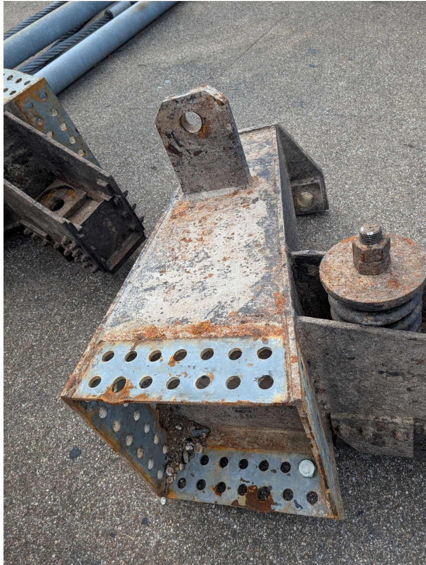
Abbildung 1: beschädigter Torarm nach fast unmöglicher Demontage
