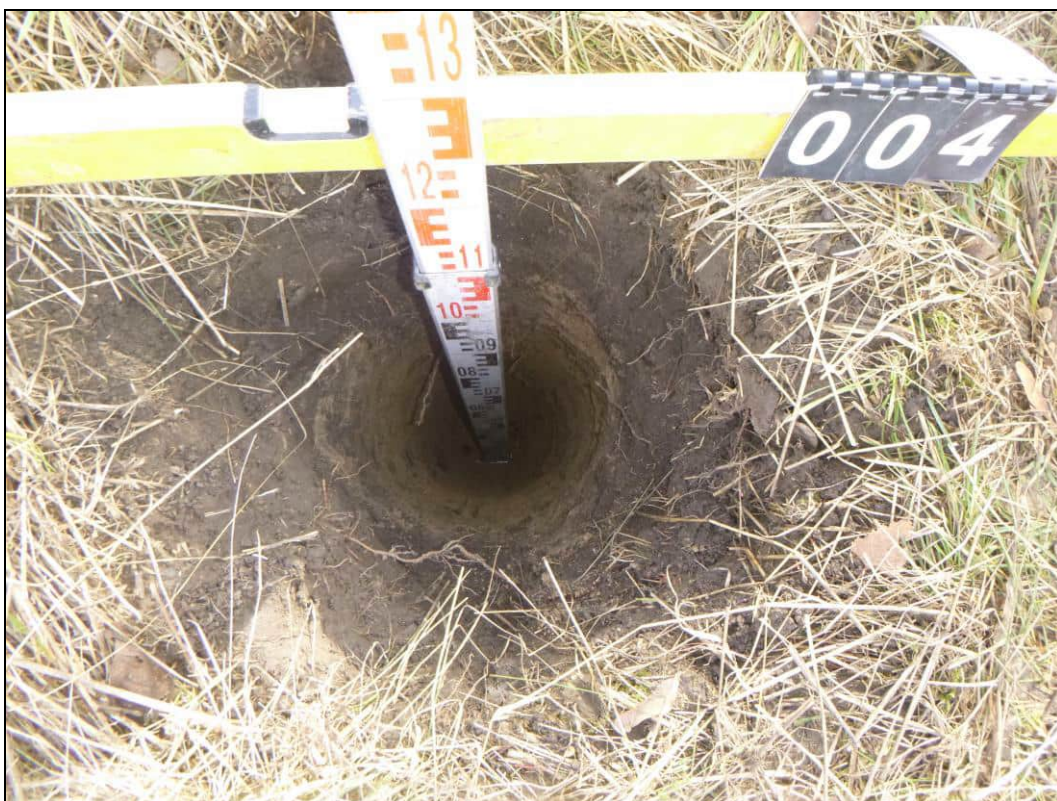
Abb. A3-10: Aufschluss Sch/KRB 4; Detail Schurfsohle bei 1,2 m u. GOK
