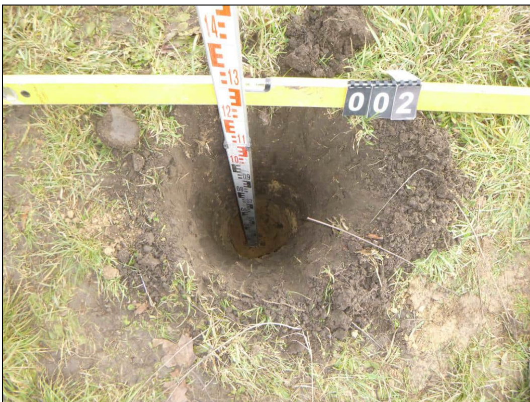
Abb. A3-5: Aufschluss Sch/KRB 2; Detail Schurfsohle bei 1,2 m u. GOK
