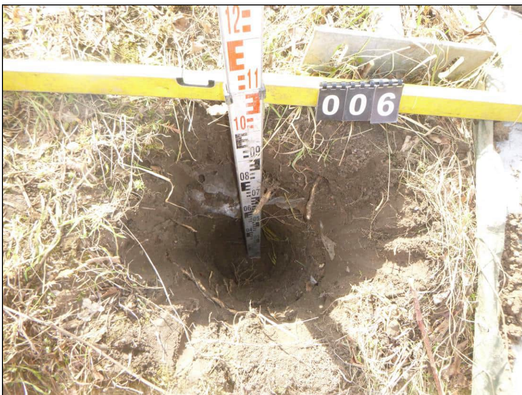
Abb. A3-14: Aufschluss SCH 6; Detail Schurfsohle bei 1,05 m u. GOK
