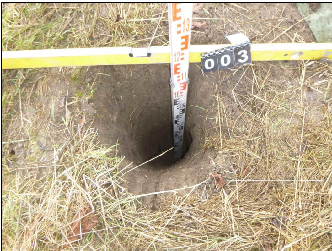
Abb. A3-8: Aufschluss Sch/KRB 3; Detail Schurfsohle bei 1,2 m u. GOK
