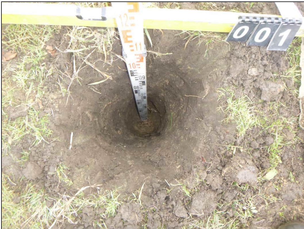
Abb. A3-3: Aufschluss Sch/KRB 1; Detail Schurfsohle bei 1,2 m u. GOK
