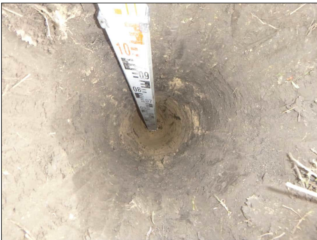
Abb. A3-6: Aufschluss Sch/KRB 2; Detail Schurfsohle bei 1,2 m u. GOK
