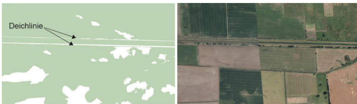
Abb. 12: Beispiel für fehlende Konnektivität. Links: Überschwemmungsflächen HQ 100 (grün) als Ergebnis der Hochwasserberechnung der Hochwasserrisikomanagement-Richtlinie mit durchgehend nicht überschwemmten, flussnahen Deichlinien, rechts Luftbild für denselben Landschaftsausschnitt (Datenquelle: s. Anhang 2, Tab. 17).
