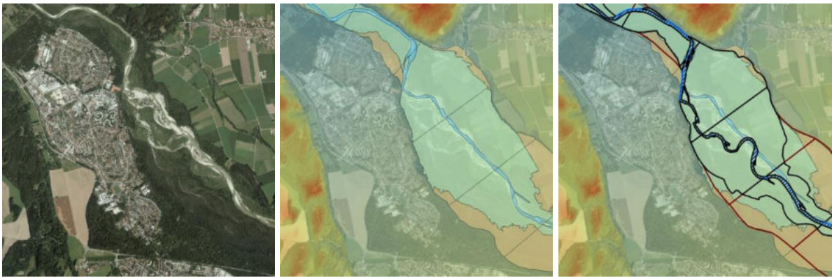
Abb. 22: Isar südlich von München bei Gartenberg. Links: aktuelles Orthophoto (WMS-Dienst BKG), Mitte: Überlagerung mit Ergebnis Auenbilanzierung 2021 (grün: rezente Aue, braun: Altaue), rechts: zusätzlich überlagert mit Auenbilanzierung 2009 (schwarze bzw. rote Linie: ehemalige rezente Aue bzw. Altaue), (Datenquelle: s. Anhang 2, Tab. 17).
