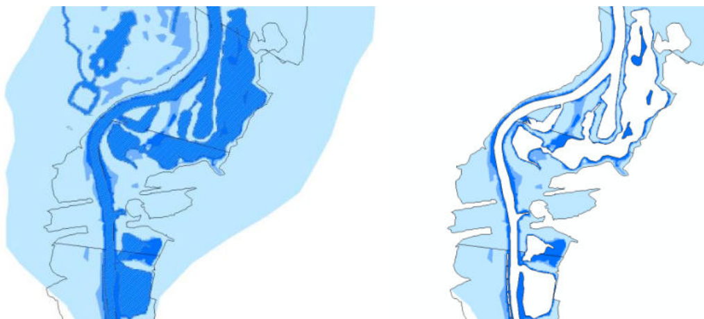
Abb. 8: Wasserflächen in der Aue über Projektion bei HQ 2 (dunkelblau), HQ 5 (mittelblau) und außerhalb HQ 5 (hellblau) der Fulda im Stadtgebiet Kassel. Links: Morphologische Aue (2009) inklusive der LBM-Objektart "Gewässer"; rechts: rezente Aue 2021; dauerhafte Wasserflächen (weiß) werden bei der Projektion nicht berücksichtigt.
