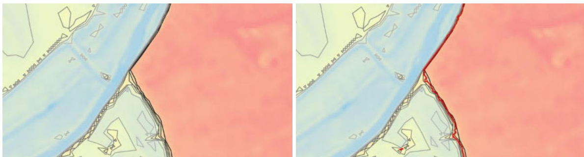
Abb. 13: DGM10 mit gescharten Linien (graue Linien) der neuen hydrologischen Berechnung (links) sowie mit Überlagerung der HQ_{\text{extrem}} -Linie in rot (rechts), bei deutlich ausgeprägtem Hochufer (Datenquelle: s. Anhang 2, Tab. 17).
