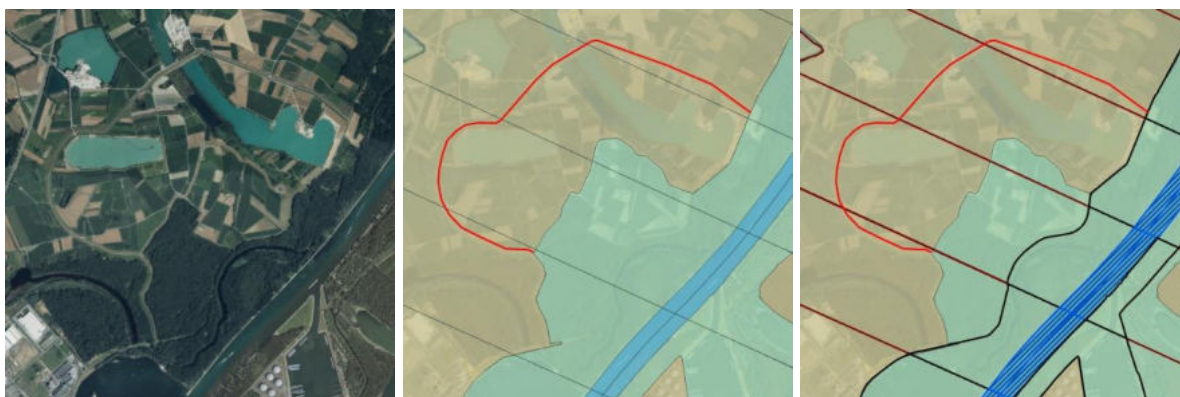
Abb. 23: Rheinpolder Wörth / Jockgrim am Rhein. Kombination von Deichrückverlegung und gesteuertem Polder. Links: aktuelles Orthophoto (WMS-Dienst BKG), Mitte: Überlagerung mit Ergebnis Auenbilanzierung 2021 (rote Linie: neuer Rheinhauptdeich, grün: rezente Aue, braun: Altaue), rechts: zusätzlich überlagert mit Auenbilanzierung 2009 (schwarze Linie: ehemalige rezente Aue), (Datenquelle: s. Anhang 2, Tab. 17).
