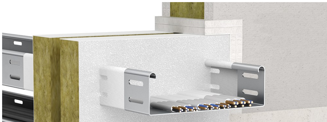
Prinzipdarstellung Trennwanddurchdringung R'_w = 45 - 47 dB mit beidseitigem Weichschott
