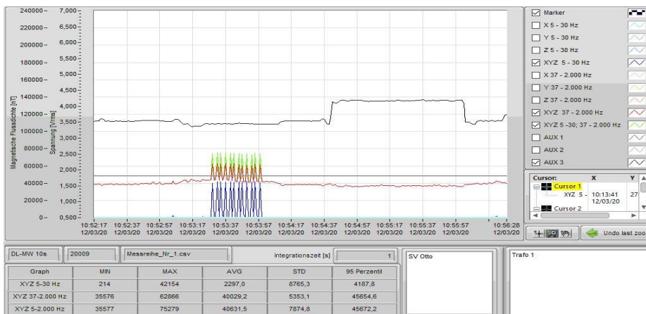
Gemessene 12 Impulse von der Schleifenwiderstandsmessung Max Test.
