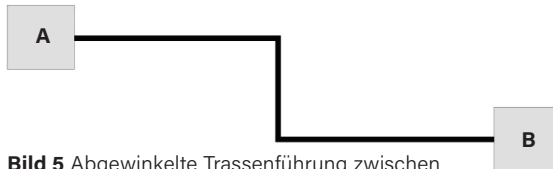
Bild 5 Abgewinkelte Trassenführung zwischen zwei Punkten, Dehnungsaufnahme innerhalb der Trasse durch Z-Bogen oder in A und B.
