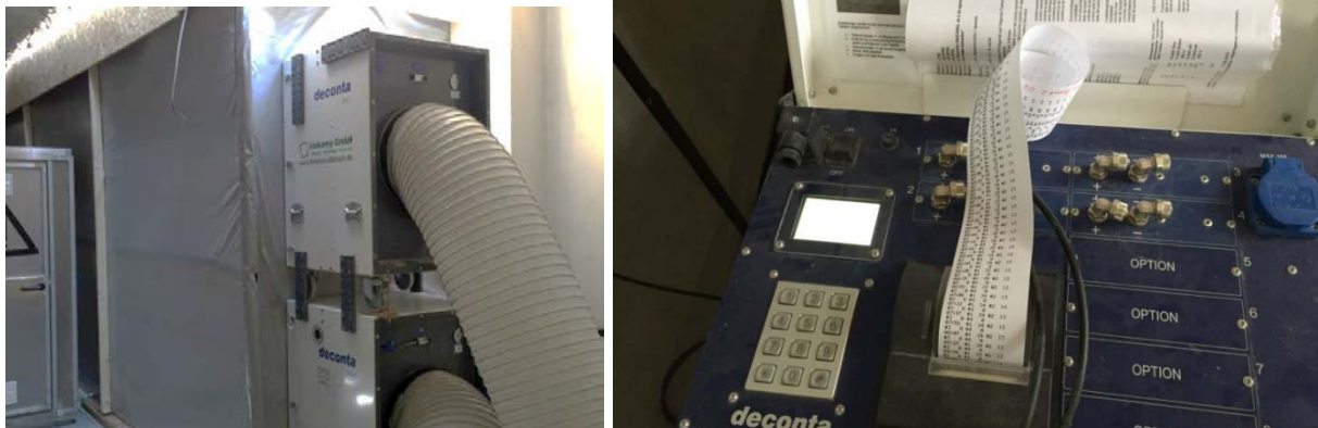
Abbildung 12: Beispielbild - Unterdruckhaltergerät (UHG), Unterdruckmessgerät
