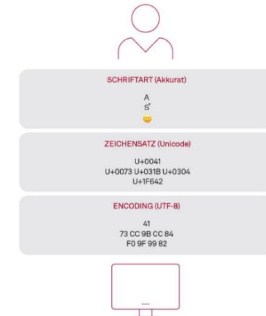
Abbildung 1: Drei Zeichen, dargestellt in der Schriftart Helvetica, als Unicode Code Points und mit UTF-8 encodiert (hexadezimale Darstellung). Häufige Zeichen wie das A benötigen weniger Bytes im UTF-8 Encoding.
