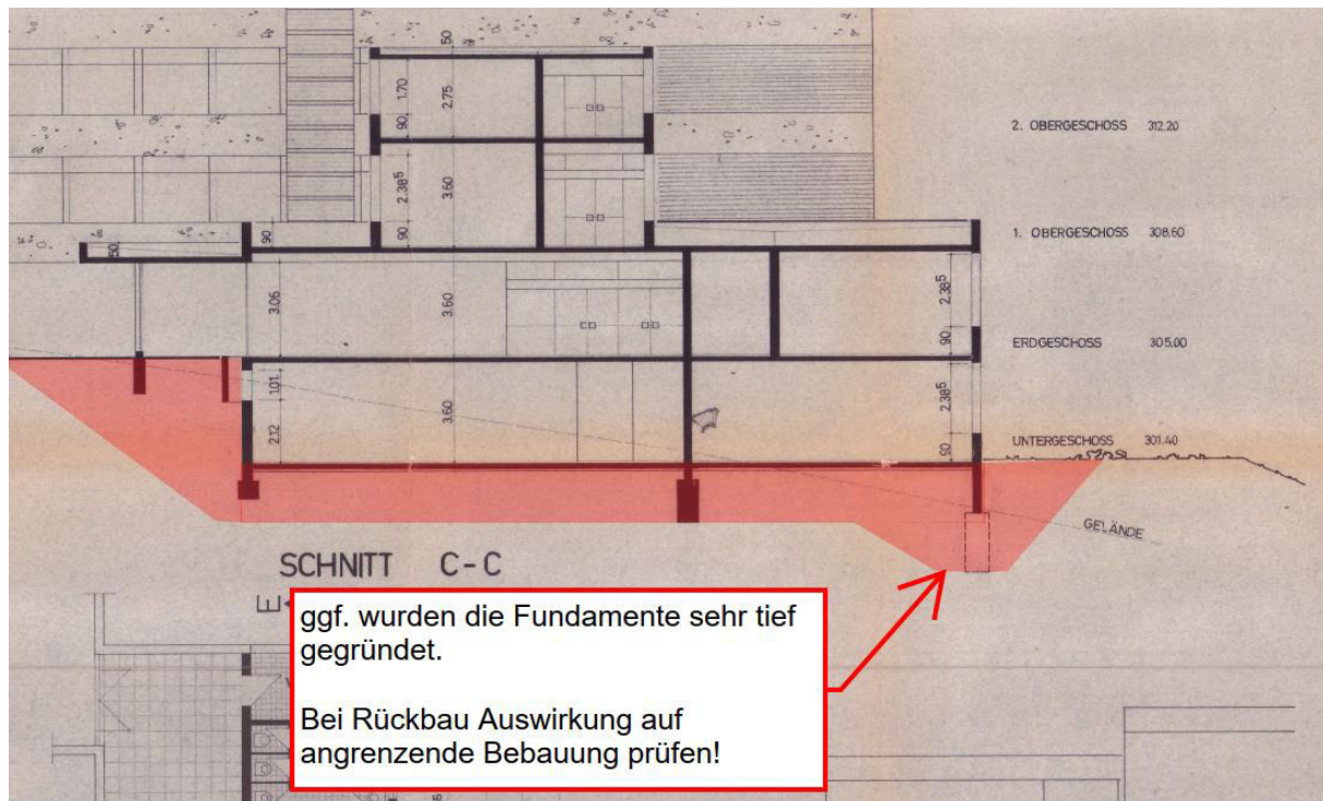
Abbildung 42: Bestandsschnitt mit angedeuteten tiefergeführten Fundamenten
