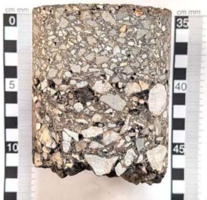
Abbildung 2: Asphaltkern von Ansatzpunkt RKS 1.
